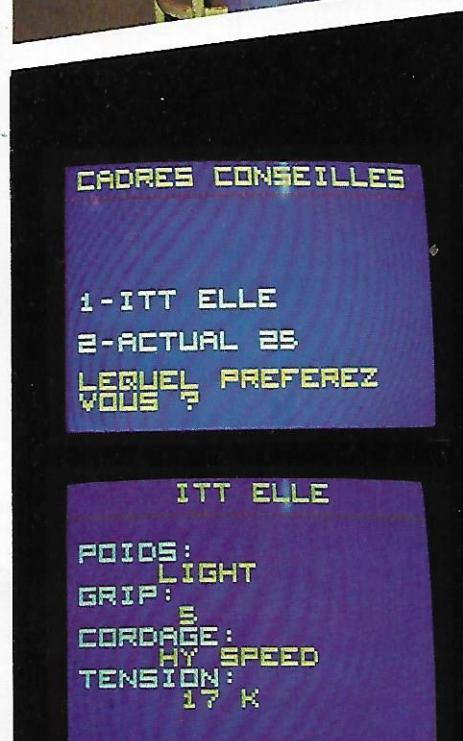
*Les informations traitées par l'ordinateur lui permettent de formuler sur l'écran le cadre le mieux adapté à la morphologie du joueur. L'appui sur une seconde touche délivrera le cordage approprié avec la tension à effectuer.*
